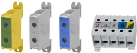
Plintarna är lämpliga för både Al- och Cu-ledare. Kan monteras med skruvfastsättning eller fastsättning på DIN-skena. Kopplingsplint 5x25 mm kan dessutom monteras vertikalt eller horisontellt.
