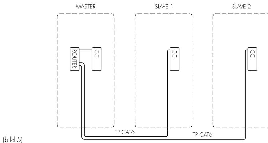
Fünf LS4 verbunden mit TP-Cat-6-Kabel an Router/Switch
