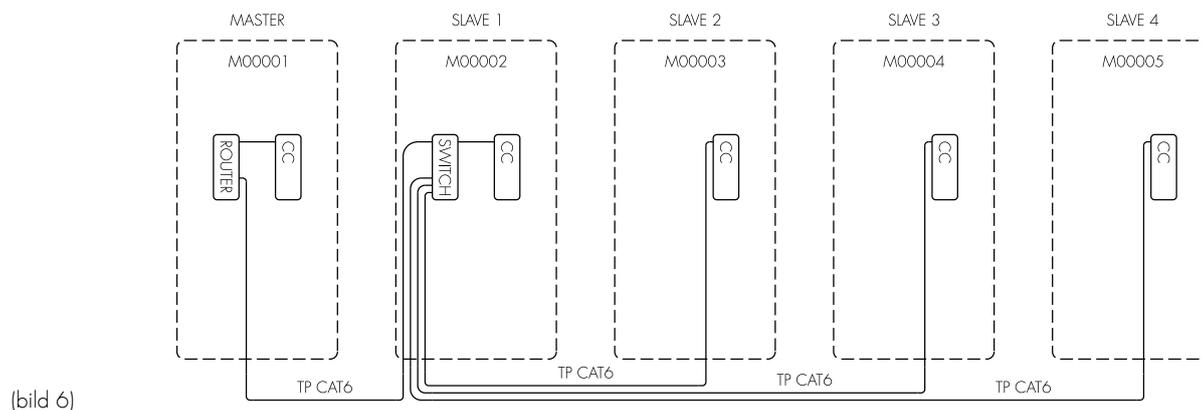
Beispiel für Anlage mit Energiezähler für dynamisches Lademanagement
