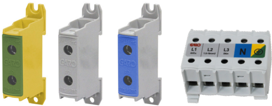
Plintarna är lämpliga för både Al- och Cu-ledare och kan monteras med skruvfastsättning eller fastsättning på DIN-skena. Kopplingsplint 5x25 mm kan dessutom monteras både vertikalt och horisontellt.
