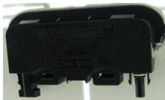
Figur 6: På varje solpanel sitter en kopplingsbox för ingående och utgående kontakt
